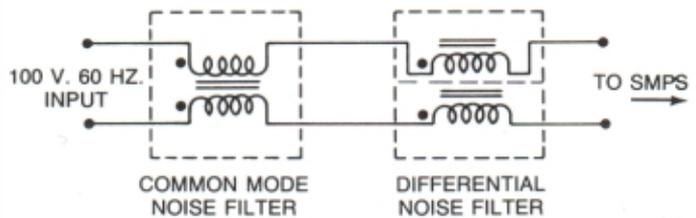
FIGURE 2: COMMON MODE NOISE (CMN) FILTER
